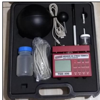
Figura 24 - Medidor de stress térmico.
